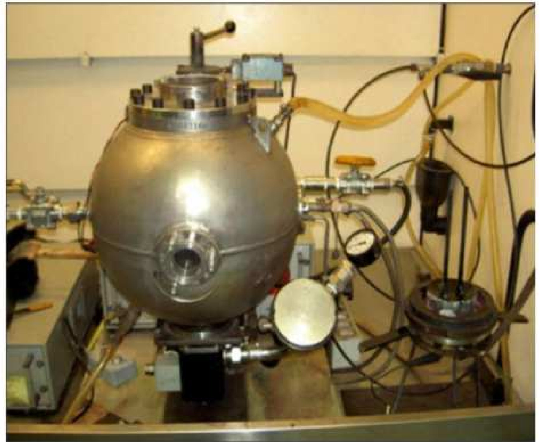
Esfera de pruebas para obtener el factor K_{ST} y P_{MAX} .
