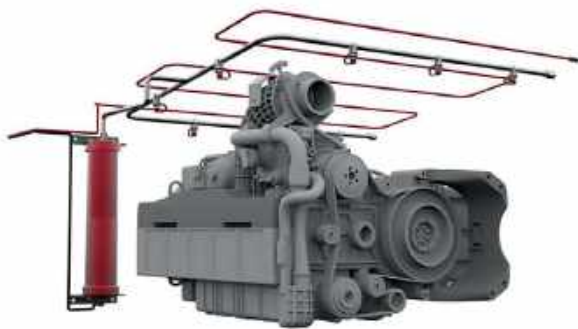
Sistema de supresión en el motor de un autobús. Fuente: Dafo Vehicle Fire Protection
