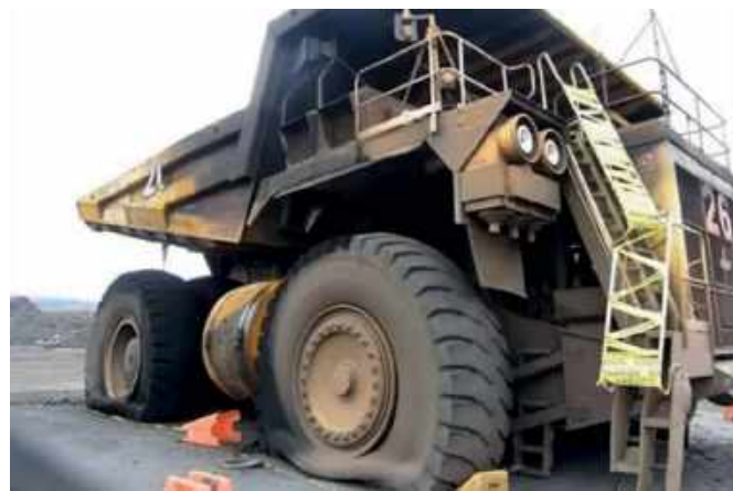
Vehículo minero luego de un incendio. Fuente: Curso sobre minería del Fire Protection Institute
