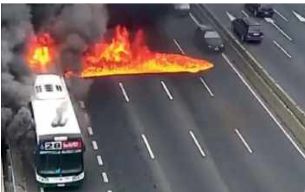
Incendio de un autobús en las afueras de Buenos Aires, Argentina, donde se aprecia el combustible incendiado luego de que el tanque plástico de combustible pierda su integridad. Fuente: Video de la Policía de Buenos Aires
